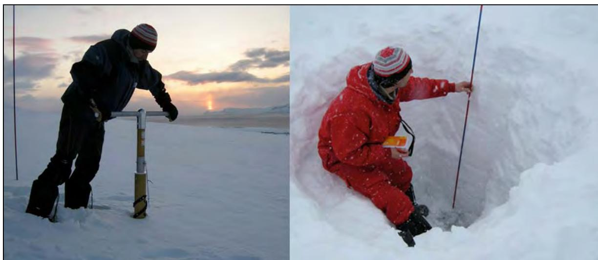
Figure 16 – Carottage au drill Pico (à gauche) et profil stratigraphique de la neige (à droite)
